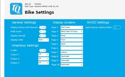
Sous l'élément de menu « Bike-Settings », les sorties nécessaires pour le changement de vitesse électronique ou l'éclairage peuvent désormais être activées.
