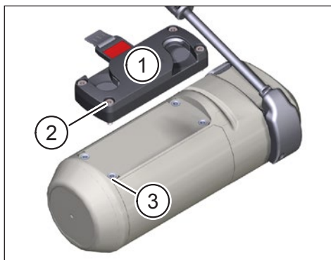
Fig. 3: Fixation du FIDLOCK® Force connector au Range Extender
