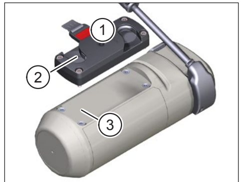
Abb. 3: Befestigen Sie den FIDLOCK® Force Connector am Range Extender
